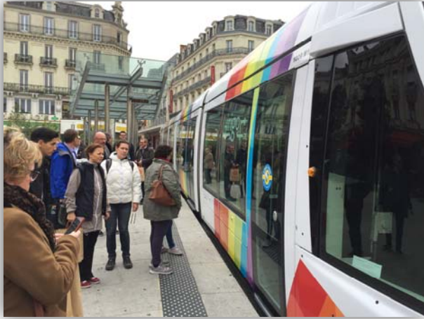
Precis i anslutning till systemets enkelspårsträcka ligger en av de större hållplatserna. Här kan vagnarna reglera sin tidhållning och vänta in mötande trafik.
